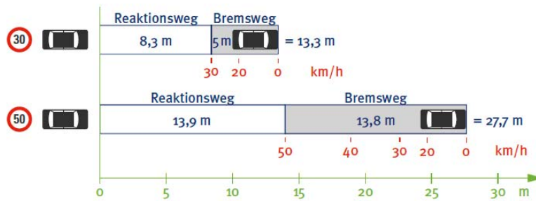
Abb. 4: Bei niedrigem Tempo reduziert sich der Anhalteweg und damit bei Unfällen die Verletzungsschwere 5
